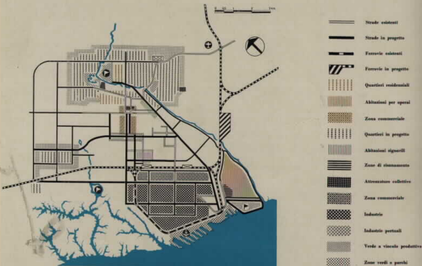
Fig. 4 - Sotto: Schema della zonizzazione in relazione al nuovo tracciato ferroviario. La città assume una nuova scala. Il sistema ferroviario si inserisce nel sistema generale della rete del trasporto urbano e favorisce la zonizzazione funzionale delle aree. Alla nuova zonizzazione si incorporano circa 20.000.000 di mq. di terreno occupati dalle installazioni ferroviarie sopresse.
