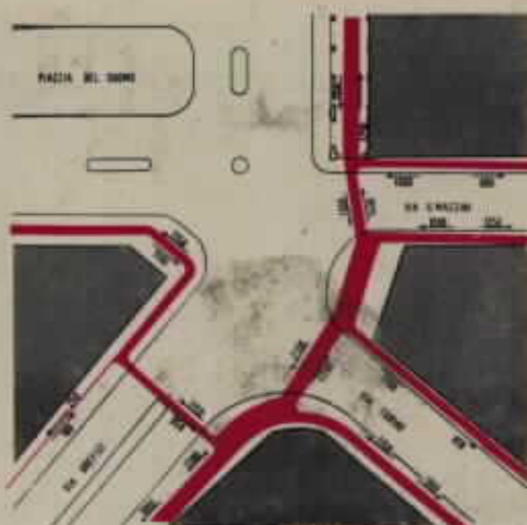
Fig. 4. - Rappresentazione del volume-orario del traffico pedonale prima della costruzione del sottopassaggio.
