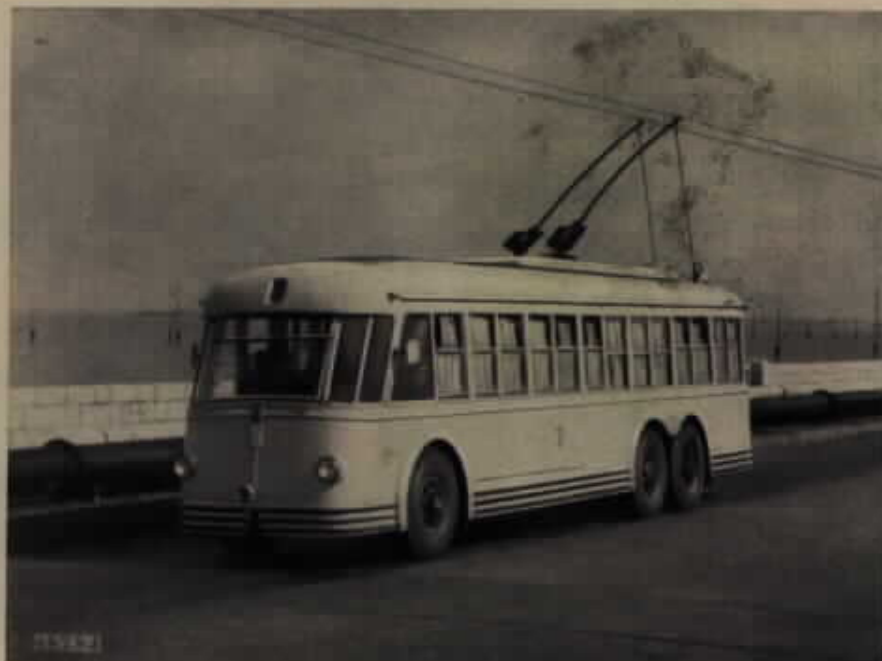
Filobus a tre assi, con equipaggiamento ad accelerazione e frenatura elettrica automatica variabile.
